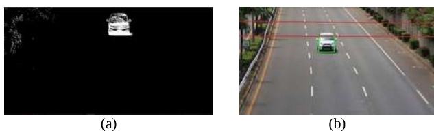
Gambar 7 Hasil pemrosesan citra: (a) citra foreground, (b) deteksi ROI pada objek yang melewati start zone
