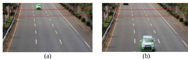
Gambar 9 Hasil deteksi kecepatan: (a) ROI pada start zone, (b) deteksi kecepatan pada objek yang melewati start zone
