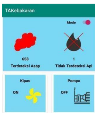
Gambar 5. Tampilan Android saat Pengujian Sensor MQ-2 dan Kipas Otomatis
